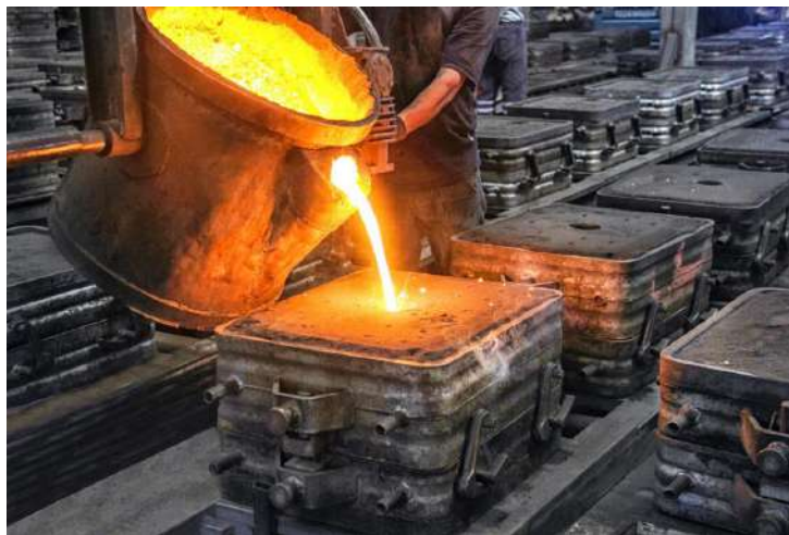
Figura 8 - Processo de fundição por gravidade.
