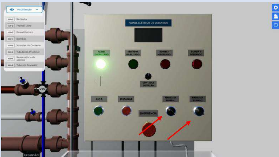
Figura 6 – Habilitação as bombas 1 e 2
