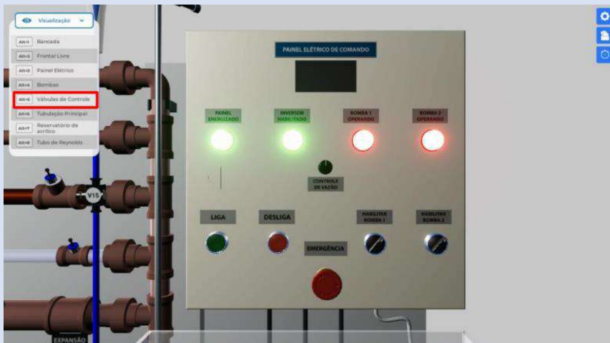
Figura 8 – Menu visualização Válvulas de controle
