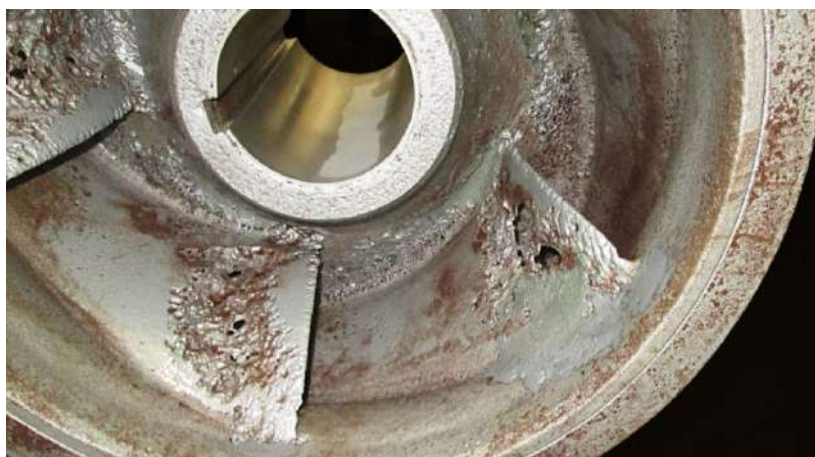
Figura 1 – Efeito da cavitação em uma bomba.
