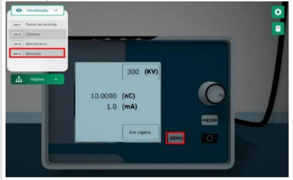
**4. Analisando os atenuadores:** Faça três exposições com os atenuadores de cobre e alumínio, com as espessuras definidas para cada um, e, anote os valores.
