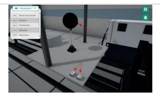
Visualize a câmera, alterando o modo de visualização para "Câmera". Tare a posição da bancada, clicando sobre o botão "Tara". Em seguida, altere a posição para 2,5 m, utilizando os botões de seta. Importante ressaltar que, após clicar em uma das setas, é necessário esperar que a bancada pare de se movimentar para clicar nas setas outra vez.
