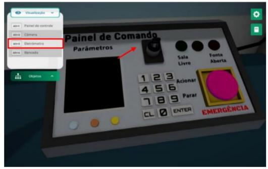
Ligue o eletrômetro com o botão esquerdo do mouse. Em seguida, zere o aparelho clicando com o botão esquerdo do mouse em "ZERO".
