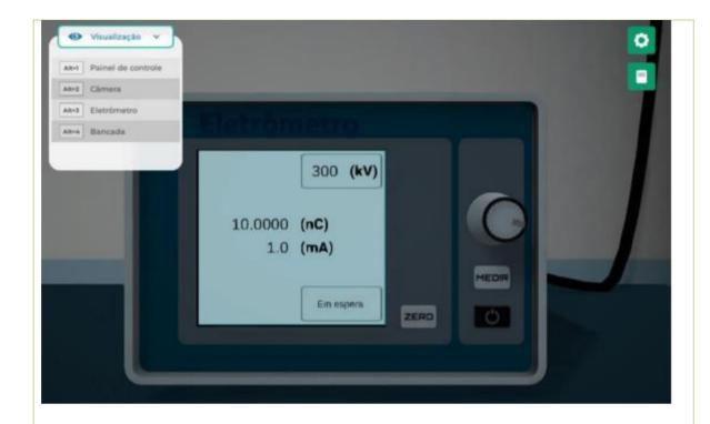
**5. Alterando as distâncias:** Na câmera, aumente a distância em 0.5 m. Zere o eletrômetro, ative novamente a função "Medir" e mais uma vez acione a emissão. Realize a leitura no visor do eletrômetro. Esse procedimento deve ser realizado 4 vezes (até alcançar a distância de 3,0 m).
