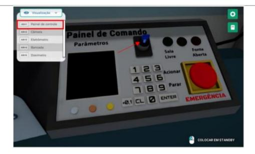
Configure o painel com os valores adequados para a qualidade N-40. Para alterar o primeiro valor, clique com o botão esquerdo do mouse sobre o botão indicado (1) e utilize o teclado numérico do painel para digitar o valor desejado. Em seguida, mude os outros valores, clicando nos botões (2) e (3).
