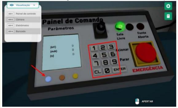
Digite o valor da intensidade da corrente elétrica necessária (1 mA) clicando com o botão esquerdo do mouse sobre o botão indicado e, em seguida, clicando sobre os números no teclado do painel.
