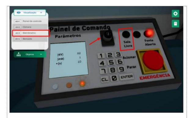
Aguarde a medição. Anote o valor obtido, zere o eletrômetro clicando com o botão esquerdo do mouse no botão "ZERO", em seguida, direcione-se ao menu "VISUALIZAÇÃO" e clique em "BANCADA".
