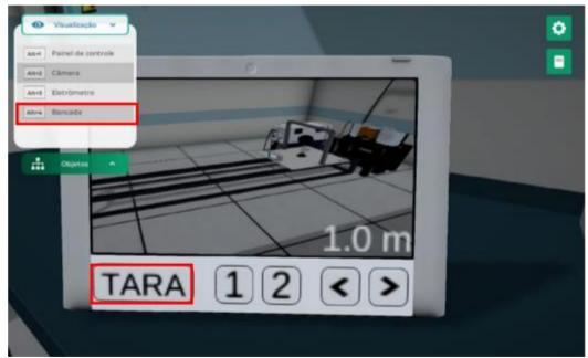
Calibre a esfera. Para isso, com o botão direito do mouse, conecte o cabo entre a câmara e o eletrômetro "Conectar/Desconectar ao eletrômetro". Em seguida, com o botão direito do mouse, clique sobre a esfera para ativar a calibração "Calibrar posição".
