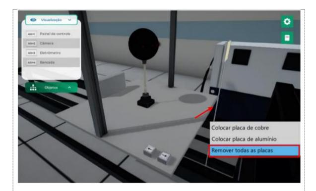
Em seguida, com o botão esquerdo do mouse clique em "COLOCAR PLACA ATENUADORA DE COBRE" ou "COLOCAR PLACA ATENUADORA DE ALUMÍNIO". Com o botão esquerdo do mouse, selecione a espessura a ser calculada e direcione-se ao menu "VISUALIZAÇÃO" e clique em "ELETRÔMETRO".
