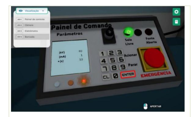
**2. Ajustando o eletrômetro:** Ligue o eletrômetro e ajuste a voltagem para 300 kV. Em seguida, zere o equipamento e acione o modo de medição.
