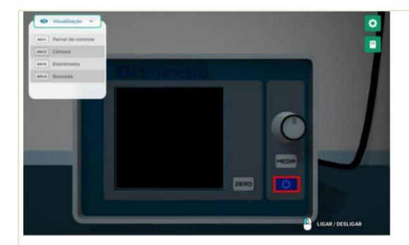
Ajuste a voltagem do eletrômetro para 300 kV pressionando o botão esquerdo do mouse sobre o botão indicado e girando-o para a direita.
