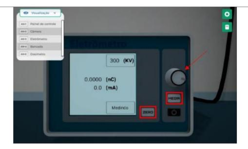
No menu "Visualização" clique em "Painel de Controle". Ligue o painel de controle, girando a chave para a posição "On". Para realizar essa ação, clique sobre a chave com o botão esquerdo do mouse. Pressione o botão verde "Sala livre" para acionar a emissão, clicando sobre ele. Perceba que o botão verde se apagará e o botão vermelho "Fonte aberta" se acenderá por alguns instantes. Aguarde até que o botão verde se acenda novamente.
