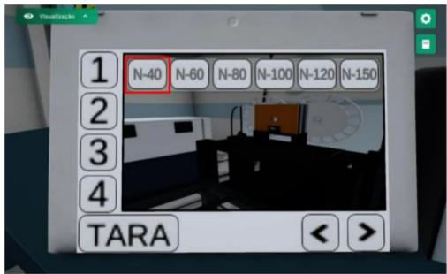
2. Configurando o painel de controle: Coloque o painel de controle em standby e configure-o com os valores adequados para a qualidade utilizada. Ligue e configure o eletrômetro em 300 kV, zere-o e selecione a função "Medir". Ligue o painel de controle e acione a emissão. Verifique os valores exibidos no display do eletrômetro.
