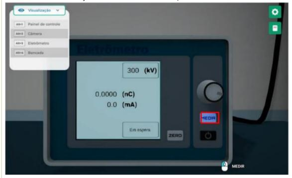
Configurando a bancada: Calibre a posição da câmara e conecte seu cabo ao eletrômetro. Ajuste a sua posição de modo que o laser de calibração fique na horizontal.
