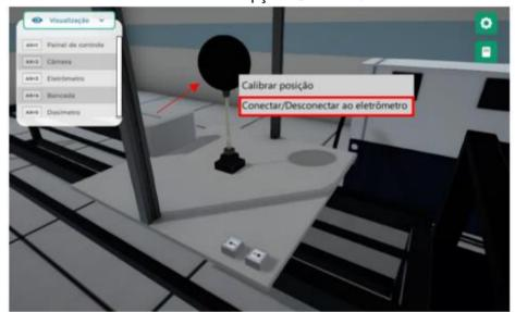
Calibre a posição da câmara. Perceba que surgirá um laser incidindo sobre a câmara. Movimente a bancada, utilizando os botões de seta destacados na imagem abaixo, até que o laser esteja aproximadamente horizontal.
