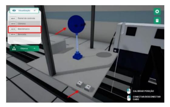
**3. Polarização:** Polarize a câmara de ionização, programe o painel de controle do raio-X, acione o feixe e anote o valore obtido.
