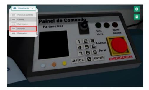
Conecte o cabo da câmara de ionização ao eletrômetro, clicando com o botão direito do mouse sobre a câmara e selecionando a opção "Conectar/desconectar ao eletrômetro".
