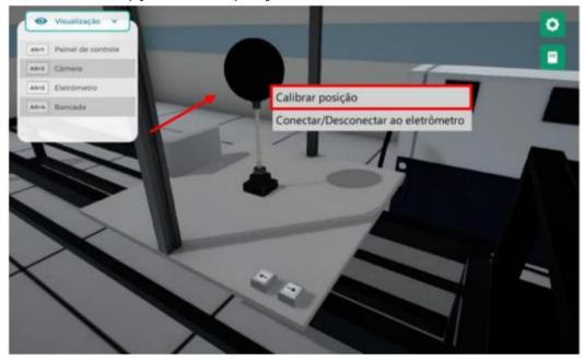
Conecte os cabos clicando com o botão direito do mouse sobre a câmera de ionização e selecionando a opção "Conectar/Desconectar ao eletrômetro".
