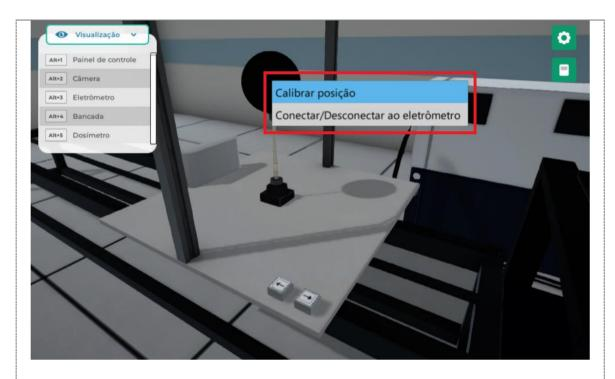
Com o botão esquerdo do mouse clique nas setas para efetuar a calibração, observando a posição do feixe, o qual deve ser posicionado na horizontal. Direcione-se ao menu "VISUALIZAÇÃO" e clique em "ELETRÔMETRO".
