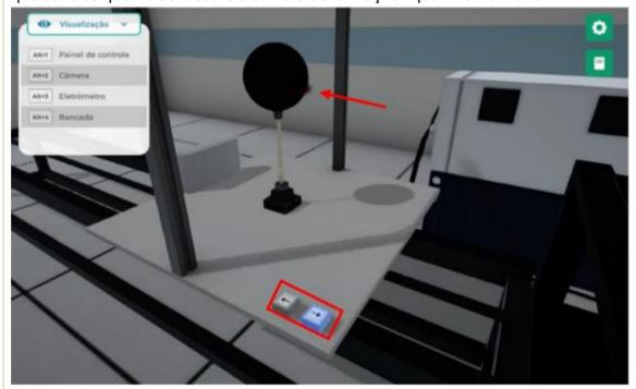
**4. Realizando o experimento:** Na câmera, tare. Logo depois, posicione a chave de segurança na opção "ON" e acionar no botão "sala livre" para acionar a emissão. Faça a leitura do resultado no visor do eletrômetro.
